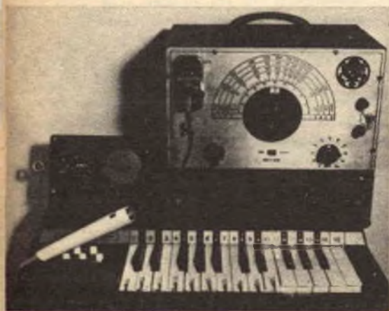
Fig. 5 - Dispositivo per effetti speciali per un organo elettronico; a destra sono montati il generatore audio e la tastiera, mentre i controlli per il sincronizzatore di cadenza, il miscelatore ed il microfano sono a sinistra.
