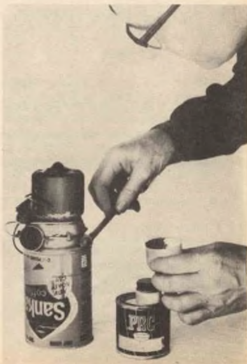
Fig. 2 - Il piccolo ventilatore si incolla nel foro praticato nella parte superiore del barattolo. La giuntura deve essere a tenuta d'aria.
