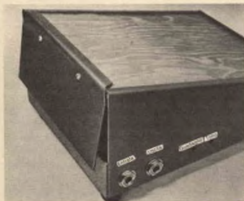
Il coperchio impedisce alla luce ambiente di colpire i fotoresistori. Un paio di viti lunghe incernierano il pedale.
