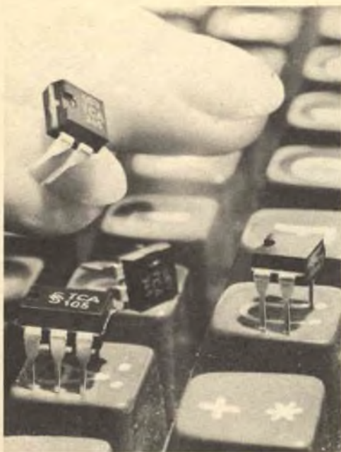
Fig. 1 - Circuiti integrati TCA 105, TCA 345 della Siemens, particolarmente adatti per l'elettronica industriale.
