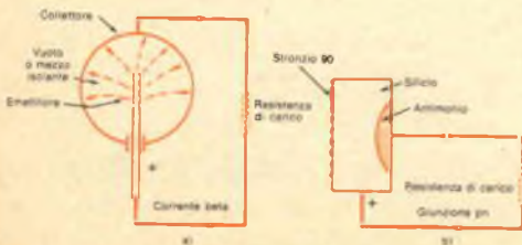
Fig. 5 - Schemi di due classici tipi di batteria che sfruttano energia nucleare.
