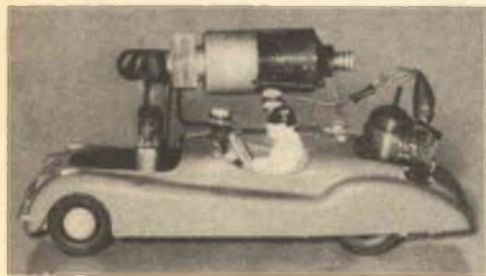
Fig. 4 - Questo modello di autovettura costruito da Huffman è azionato da un convertitore a termotunnel.
