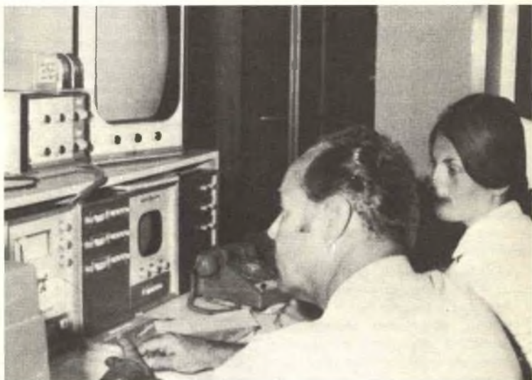
Il tecnico elettronico maneggia molti complessi monitor come questo sistema cardiaco a sette canali, sul cui funzionamento un tecnico ed un'infermiera stanno discutendo.
