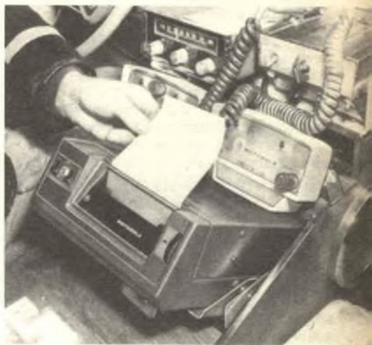
L'agente di un'autopattuglia provvista di telescrivente riceve la risposta stampata ad una sua richiesta.
