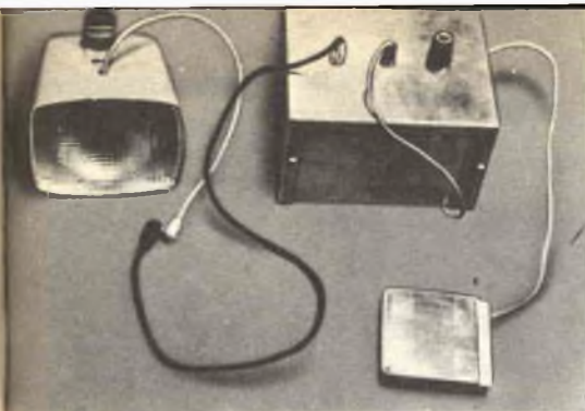
Il flash (in alto a sinistra), la scatola con il circuito ed il microfono devono essere collegati come illustrato in questa fotografia.
