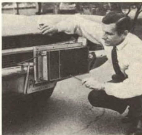
Il trasmettitore radar viene montato sul paraurti anteriore o dietro la griglia anteriore della vettura.
