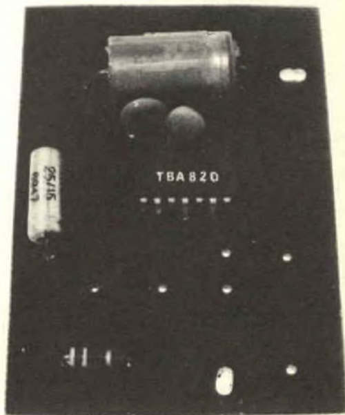
Fig. 6 - Amplificatore audio integrato TBA 820 della S.G.S. - ATES.
