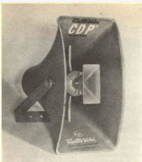
Altoparlante per impianti di amplificazione, dotato di due trombe, una per le frequenze alte e l'altra per le frequenze basse e medie. Se montato come illustrato nella foto, ha un largo angolo di dispersione orizzontale.
