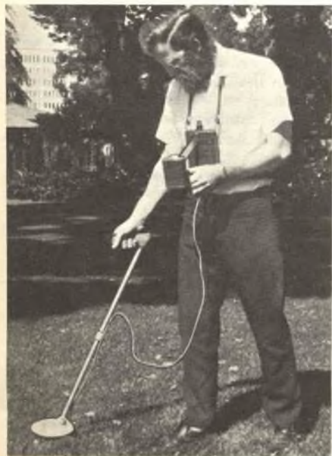
Fig. 2 - Nel cercametalli Fisher Explorer II, la parte elettronica è montata a parte e provvista di una cinghia che il ricercatore appende al collo.
