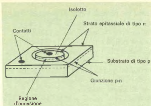
Fig. 4 - Disegno schematico di un catodo che presenta un taglio anulare, anziché un foro.
