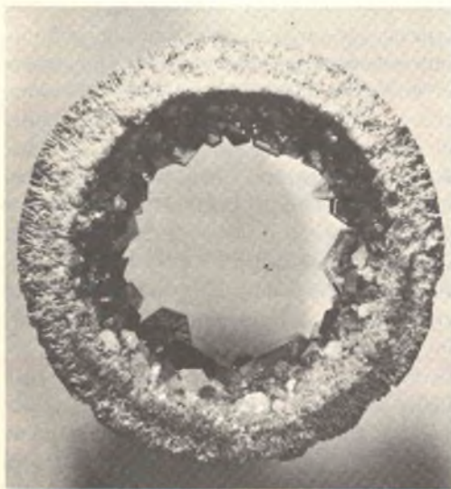
Fig. 1 - Crescita dei cristalli di carburo di silicio 6H tipo p, prodotti nella fornace a sublimazione.
