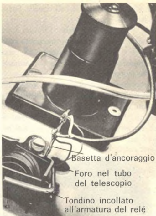
Il relé di trasmissione-ricezione è montato sul tubo del telescopio; la fotocellula ed il tondino passano attraverso un foro praticato nel tubo del telescopio.
