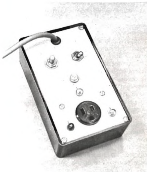
Il pannello frontale presenta una buona estetica. Il rottore è del tipo con pulsante per la rimessa. La lampadina 2 segnala il pericolo.
