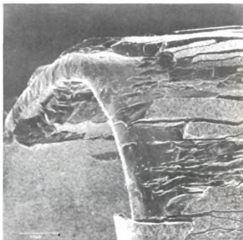
Osservazione di un sottile strato di ossido su un pezzo di rame ricurvo, con uno Stereoscan.
