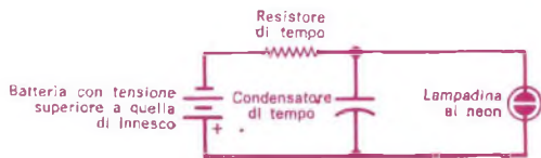
Fig. 2 - Il circuito oscillatore con lampadina al neon è composto solo da un alimentatore, da un resistore limitatore di corrente, da un condensatore da caricare e da una lampadina al neon. Il resistore deve avere un valore di circa 100 kΩ.
