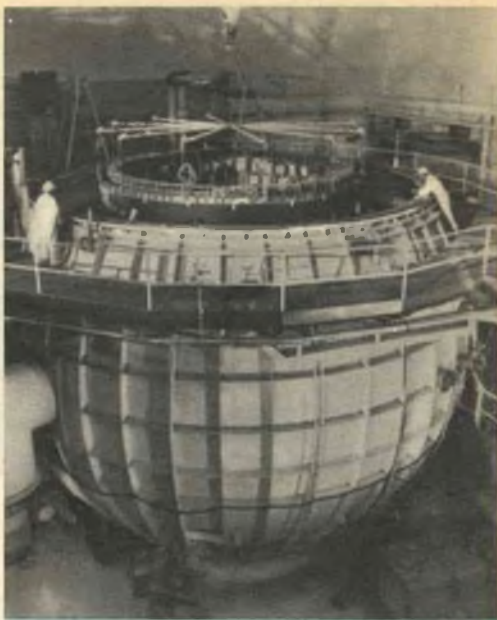
Fig. 2 - Un'unità strumentale viene introdotta in un simulatore che consentirà di collaudarla nelle condizioni in cui si troverà nei voli verso la Luna.
