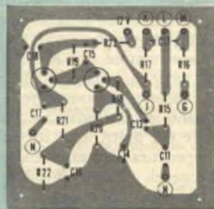
Fig. 6 - Sistemazione dei componenti sul lato opposto alle piste di rame. L'amplificatore è a sinistra ed il controllo dei toni a destra.
