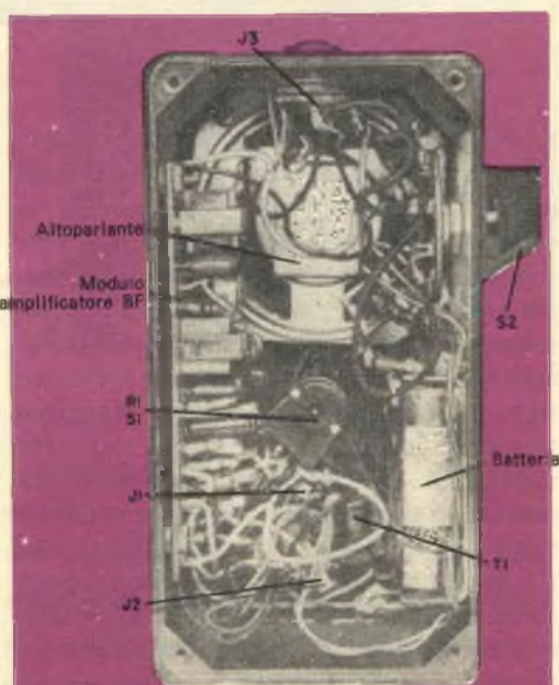
Fig. 2 - Sulla scatola possono essere montati un altoparlante miniatura da 8 \Omega ed un commutatore per l'ascolto in cuffia od in altoparlante.
