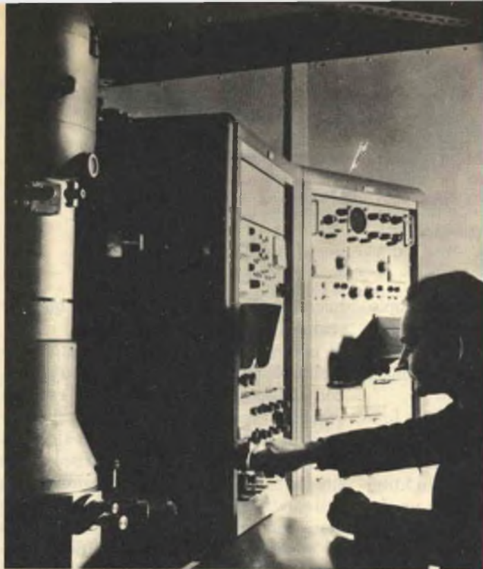
Fig. 1 - Ecco il microscopio elettronico esplorativo Stereoscan; si possono vedere la colonna elettronico-ottica e gli schermi per le immagini.
