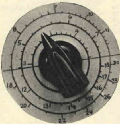
Fig. 4 - La scala, qui riprodotta in grandezza naturale, deve essere marcata al momento della taratura dello strumento. L'indice deve essere posto in senso orizzontale e fissato saldamente con il condensatore C1 completamente chiuso.
