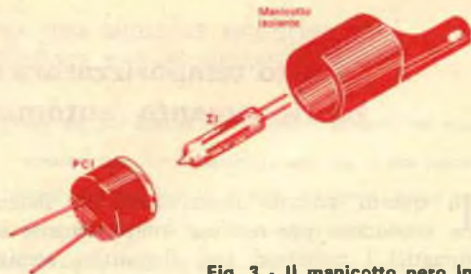
Fig. 3 - Il manicotto nero inserito su PC1 ed I1 evita che il funzionamento dell'insieme possa essere disturbato dalle fonti di luce esterna.
