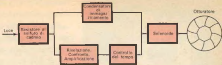
Fig. 1 - Il sistema di otturazione effettua una regolazione automatica per ogni condizione di luce e consente un'esposizione perfetta, ogni volta che si fa scattare l'otturatore.
