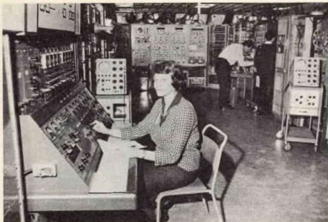
Mensola di controllo dell'interferometro della stazione radiorecevente di Winkfield, in Inghilterra, installata per ricevere i segnali emessi dal satellite angloamericano UK2.
