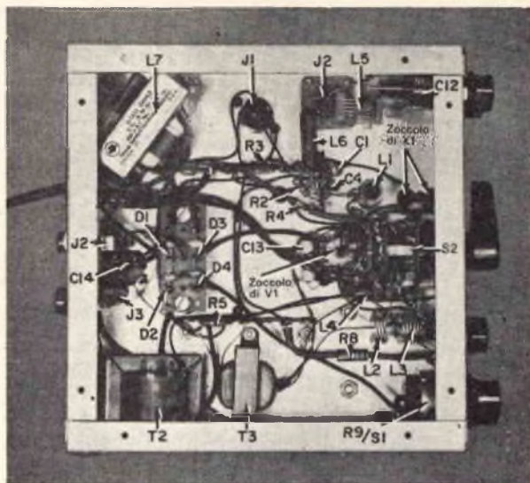
Il ricetrasmittitore per i 6 m ultimato deve essere simile a quello rappresentato in queste due foto. La parte sottostante del telaio non è stipata di componenti tranne che vicino a V1 e S2, sui quali si devono fare i collegamenti con cura.
