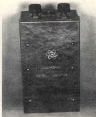
L'apparecchio completo può essere comodamente sistemato in una scatola delle dimensioni di 13 x 8 x 6 cm. Per metterlo in funzione basta semplicemente innestare la bobina di ricerca nel jack J1 e la cuffia o l'altoparlante nel jack J2.
