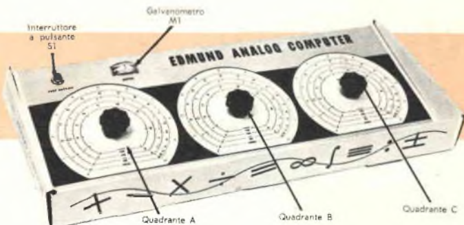
Fig. 7 - I componenti che compaiono sul pannello della calcolatrice prodotta dalla Edmund Scientific Co. sono qui indicati, con riferimento a fig. 5; ciascun quadrante ha 4 scale concentriche.
