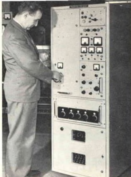
Prototipo del trasmettitore da 500 W NT204 che la Marconi ha in costruzione per la Marina Militare inglese; è l'unico trasmettitore al mondo che permette l'accordo continuo su tutte le gamme, sia a medie sia ad alte frequenze, della Marina.
