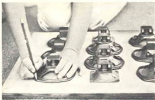
Disponete gli altoparlanti sui relativi pannelli e contrassegnate i fori di fissaggio facendo passare la mina di una matita nel foro di ciascun cestello.
