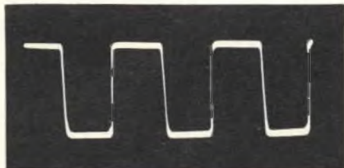
Segnale in uscita dal generatore di onde quadre quando funziona con un segnale d'ingresso sinusoidale a 1.000 Hz, visto all'oscilloscopio. Notate la ripidità dei fianchi e la linearità dei vertici.
