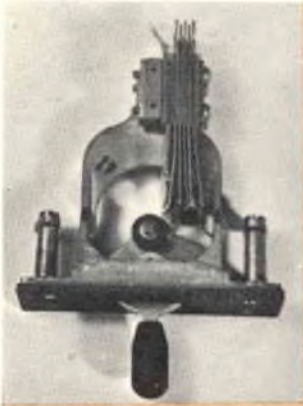
Fig. 6 - Commutatore a tasto di tipo telefonico che effettua la commutazione del transistor dal circuito dell'amplificatore al circuito di prova di fig. 5. Per inserire il microamperometro da 25 \mu A f. s. si devono usare i contatti a chiusura ritardata.
