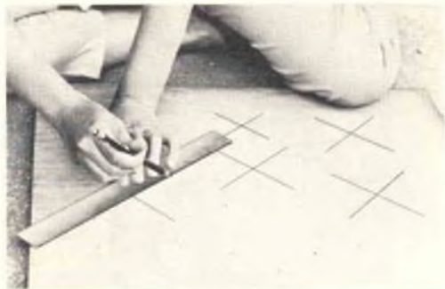
Dopo che i fori di montaggio degli altoparlanti sono stati contrassegnati, si devono tracciare e poi tagliare i fori destinati agli altoparlanti stessi.
