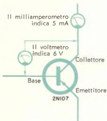
Fig. 1 - La potenza trasformata in calore nella giunzione collettore-base viene determinata calcolando il prodotto della tensione per la corrente che percorre la giunzione.
