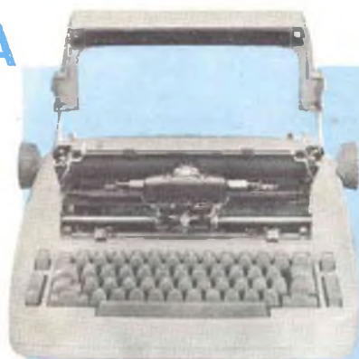
La IBM 72: al centro, di fronte al carrello fisso, sono visibili la parte superiore della sfera metallizzata o nucleo scrivente e l'originale caricatore del nastro, facilmente e rapidamente sostituibile.
