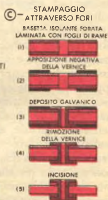
Fasi successive nella costruzione di tre tipi diversi di circuiti stampati.
