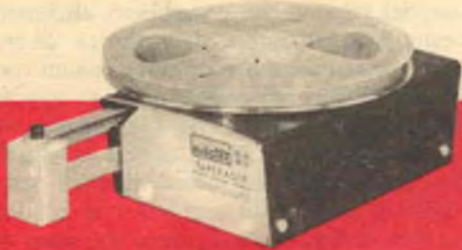
Gli apparecchi di cancellazione istantanea sono molto pratici e molto semplici da usare, e contribuiscono notevolmente a migliorare la qualità delle registrazioni.
