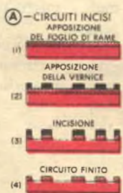
Fasi successive nella costruzione di tre tipi diversi di circuiti stampati.
