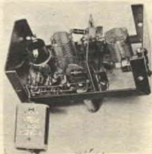
Fig. 3 - Sezioni del modulatore e dell'oscillatore a cristallo della versione a 4 transistori. Si notino i due conduttori di riferimento: uno isolato dallo chassis, costituente il polo negativo generale, l'altro funzionante da terra comune.
