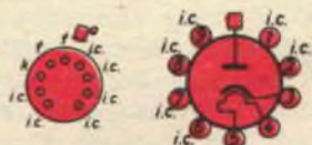
Zoccolo e connessioni del tubo EY84
