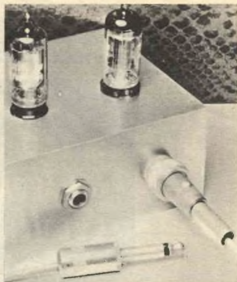
2 Ecco lo stesso soggetto della foto 1, con le stesse luci, ma con le parti lucide opportunamente appannate; notate la minore riflessione ed il maggiore dettaglio.
