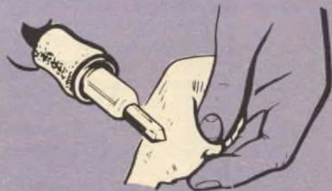
Strofinare con uno straccio pulito per rimuovere lo stagno in eccesso.
