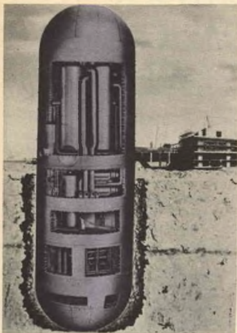
In Germania, vicino a Francoforte sul Meno, è in costruzione un reattore ad acqua bollente da 15.000 kW; questo tipo elimina gli scambiatori di calore poiché il refrigeratore aziona direttamente le turbine. Il reattore è in parte sotterraneo per motivi di sicurezza.
