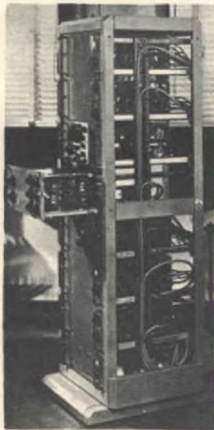
6 Le frequenze che hanno subito distorsioni di fase durante il viaggio lungo il cavo sono corrette mediante equalizzatori prima che il segnale sia demodulato.
