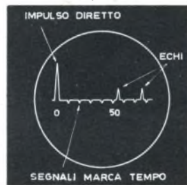
Fig. 5 - Scala oscillografo radar lineare (scansione tipo A).
