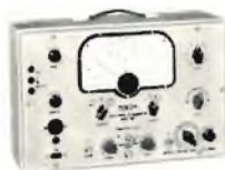
GENERATORE DI SEGNALI TV mod. 222 volutatore - calibratore generatore di barre orizzontali
