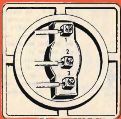
Fig. 5 - I normali commutatori, attualmente disponibili sul mercato sono di tipo a tasto e internamente si presentano come qui sopra rappresentato.
