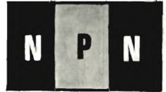
Fig. 9 - Il transistor è un componente radioelettrico che scaturisce dalla unione di tre pezzetti di cristallo di germanio, come indicato nei due disegni. Le combinazioni dei cristalli danno luogo alla composizione di due tipi fondamentali di transistori. PNP e NPN.
