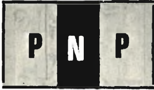
Fig. 9 - Il transistor è un componente radioelettrico che scaturisce dalla unione di tre pezzetti di cristallo di germanio, come indicato nei due disegni. Le combinazioni dei cristalli danno luogo alla composizione di due tipi fondamentali di transistori. PNP e NPN.
