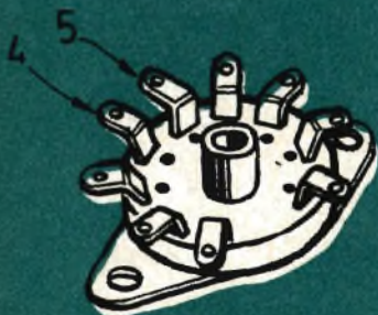
Fig. 8 - Nelle valvole di tipo Noval il filamento corrisponde ai piedini 4 e 5 dello zoccolo.
