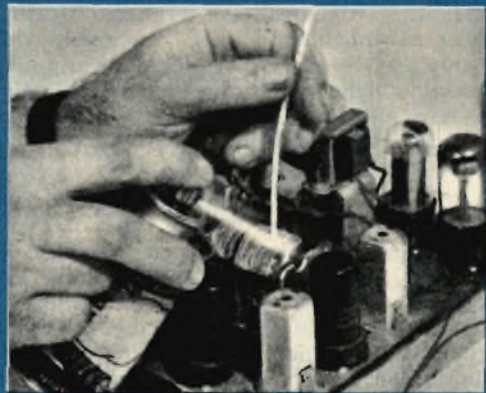
Fig. 10 - Una bomboletta spray ed una cannula flessibile possono utilmente sostituire il pennello e l'aspirapolvere nelle operazioni di pulizia delle lamine del condensatore variabile. La cannula permetterà di soffiare energicamente nei punti di maggiore accumulo.
