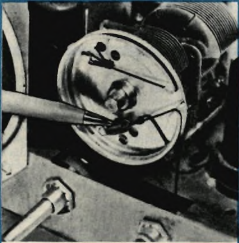
Fig. 7 - La molla di tensione della meccanica della scala parlante si allenta col passare degli anni e con l'uso del ricevitore, rendendo instabile l'indice della scala: in questi casi occorre senz'altro sostituire la vecchia molla con una nuova.
