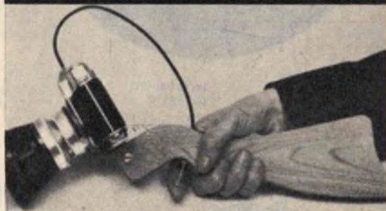
Fig. 4 - A differenza della precedente illustrazione, in questa si nota l'applicazione al calcio, mediante l'impiego della sbarretta metallica descritta nel testo.
