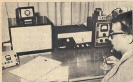
Fig. 2 - Complesso ricetrasmittente per i 144 MHz. Appartiene al radiante i 1LU da Milano.
