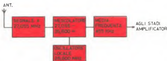
Fig. 2 - Schema logico della conversione di frequenza. Il segnale d'antenna viene mescolato con quello dell'oscillatore locale: si ottengono così 455 KHz.
