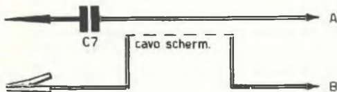
Fig. 4 - Conferendo al condensatore C7 il valore di 10.000 pF - 1.500 V., si può ottenere una sonda in grado di isolare le tensioni continue fino al migliaio di volt.
