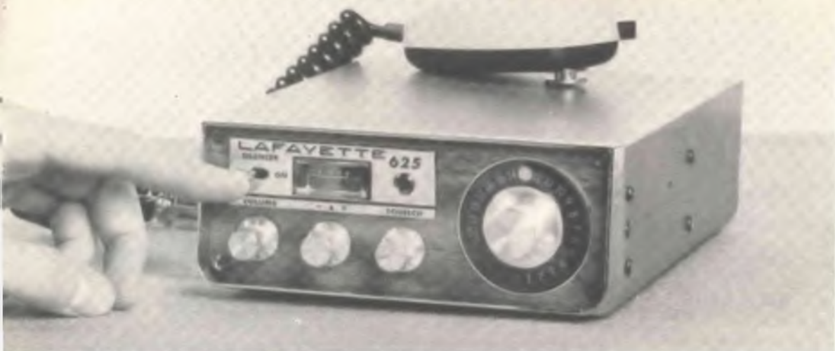
Fig. 3 - Il ricetrasmittente Lafayette HB 625 è dotato di circuito SQUELCH e di NOISE - LIMITER (limitatore di disturbi); nella foto si nota che l'operatore sta manovrando l'interruttore relativo a questo secondo circuito.
