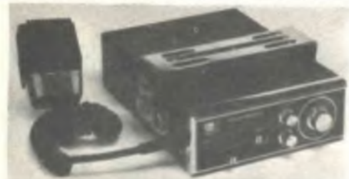
Ricetrasmittitore FANTAVOX SSB-1M. E' dotato di 23 canali. Il circuito è pilotato con 22 transistor, 2 FET, 23 diodi, 2 termistori.
