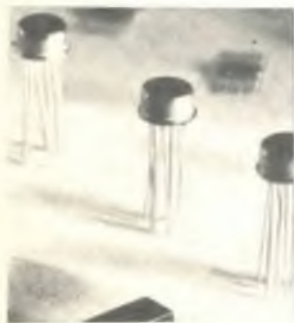
Fig. 1 - I circuiti integrati comprendono un discreto numero di transistor, diodi e resistenze in un piccolo contenitore. Il circuito integrato, quindi, sostituisce un ingombrante circuito classico, formato da tanti componenti quanti sono quelli dell'integrato.
