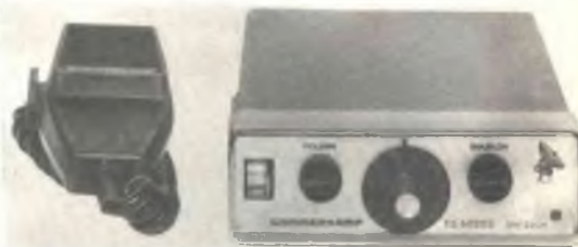
Ricetrasmittitore SOMMERKAMP mod. TS-5025 S. 23 canali equipaggiati di quarzo. Indicatore intensità segnale. Controllo volume e squelch. Presa di microfono, antenna, altoparlante esterno e per P.A. Banda di emissione: C.B.; potenza ingresso stadio finale: 5 W; uscita audio: 500 mW; alimentazione: 12 Vc.c.; dimensioni: 60 x 165 x 250.
