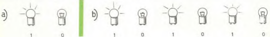
Fig. 3 - Uno dei sistemi più sfruttati a scopi didattici, rappresentativo dei livelli di tensione alti e bassi, è quello che utilizza le lampadine. Una lampadina accesa sta generalmente a significare il livello «1», mentre una lampadina spenta può significare lo stato «0».
