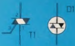
Fig. 1 - Simboli elettrici dei nuovi componenti elettronici denominati Triac (a sinistra) e Diac (a destra).
