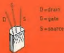
Fig. 3 - Disposizione degli elettrodi nel transistor Mos di tipo 2N3819.
