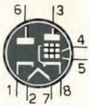
25A7 DIODO-PENTODO RADDRIZZ. FINALE B.F. (zoccolo octal)
