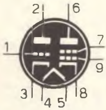
19CL8A TRIODO-TETRODO PER USO TV (zoccolo noval)
