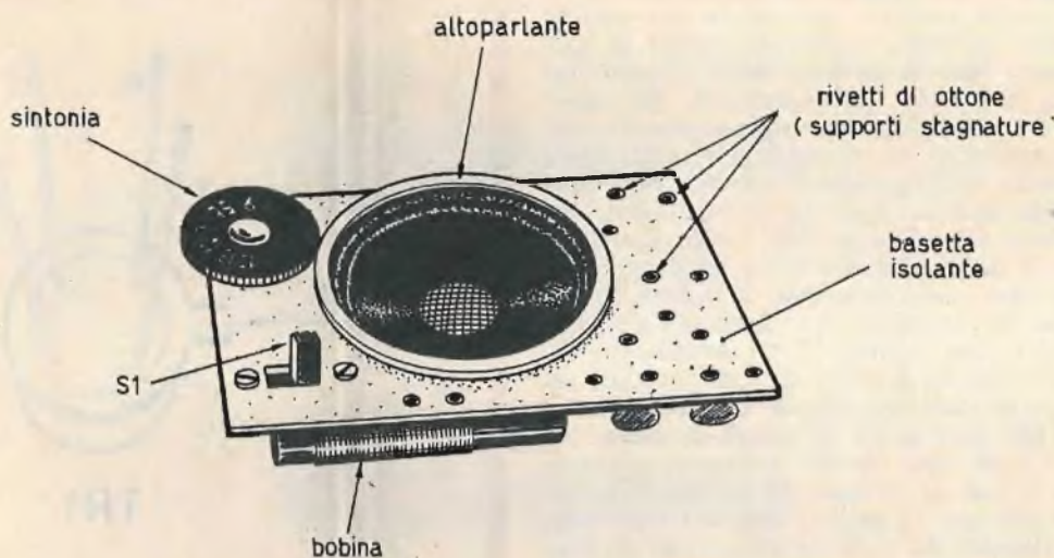
Fig. 5 - Il piano di cablaggio del ricevitore è interamente realizzato su una delle due facce della basetta isolante; sulla faccia opposta sono applicati: l'altoparlante, l'interruttore e il bottone di comando di sintonia.
