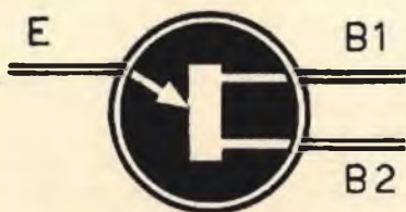
Fig. 1 - Simbolo elettrico del transistor unigiunzione. Il verso della freccia sta ad indicare che la sbarretta di silicio è di tipo N.
