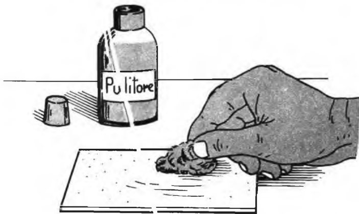
Fig. 1 - La prima operazione da farsi è quella di pulire la superficie di rame mediante un batuffolo di cotone impregnato di « pulitore ».
