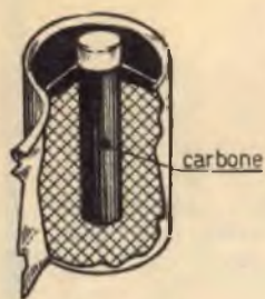
Fig. 3 - I granuli di carbone si ottengono frantumando il bastoncino nero presente in ogni elemento di pila a secco.
