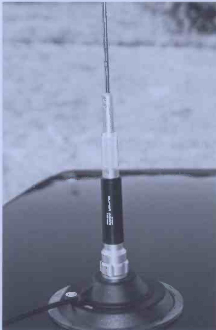
de fábrica únicamente tengas que sacarla de la bolsa, enrosarla en la base magnética, ponerla sobre la carrocería del coche y comenzar a transmitir. En todo caso, si se desea variar la banda de operación o dejar la ROE mínima en la zona de repetidores o fuera de ella, no
