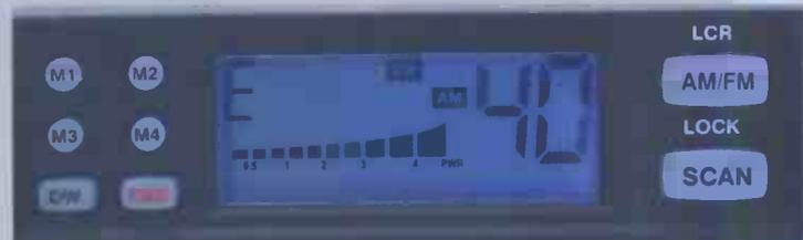
Aunque en la parte posterior hay una toma para medidor exterior, si no eres demasiado quisquilloso con ese tipo de mediciones podrás fiarte del instrumento de medición del equipo ya que está bien calibrado. Como se comprueba en la tabla adjunta, el medidor tiene una diferencia de 15 dB entre cada dos unidades, salvo en el último tramo que pasa a ser de 19 dB.
