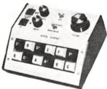
re  $U_4$  in configurazione a matrice. Ciascun pulsante è collegato a una linea orizzontale (riga) e a una linea verticale (colonna) della matrice di codificazione (Fig. 2).
