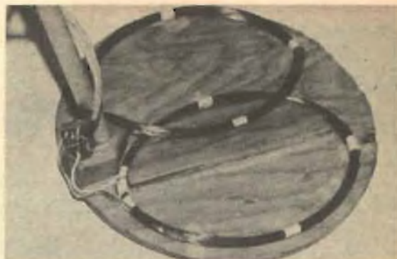
Foto 2. Questo primo piano della testa di ricerca mostra la posizione delle bobine L_1/L_2 e L_3 e le loro rispettive sovrapposizioni.
