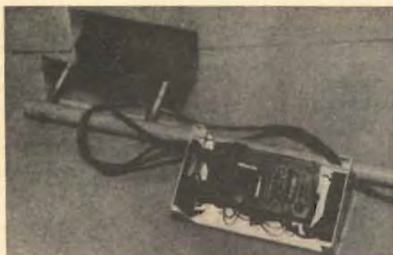
Foto 1. La foto mostra la basetta del circuito montata nell'astuccio e il sistema usato per fissare il coperchio dell'astuccio al manico.
