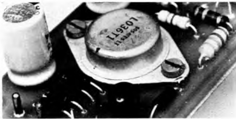
Nell'immagine, particolare della basetta costituente la parte attiva del termostato. Sotto, diagramma in cui è evidenziata la fluttuazione a cui è soggetta la sonda NTC. È necessario tenere in evidenza questo fenomeno durante la fase di taratura.
