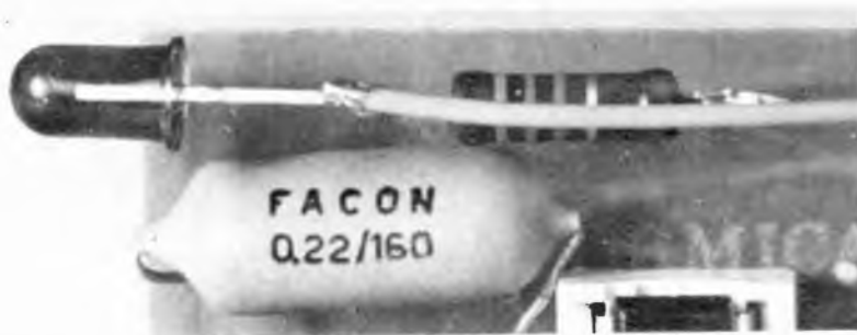
Particolare circuitale: per il funzionamento dell'integrato si usano solo componenti passivi, ossia resistenze e condensatori.
