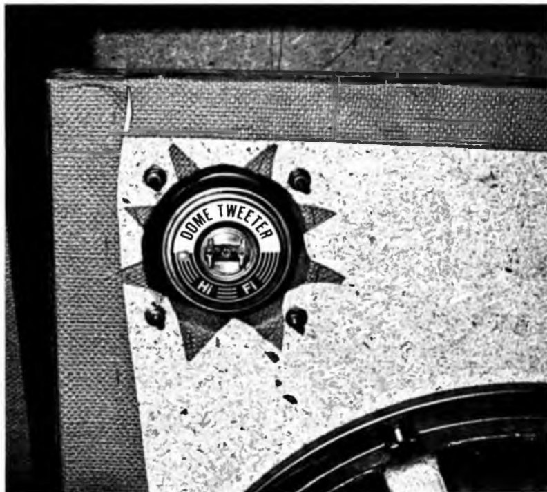
Particolare della cassa acustica. Per ottenere un elevato rendimento alle frequenze maggiori dello spettro audio sono stati utilizzati due Tweeter del tipo riprodotto nell'immagine.
