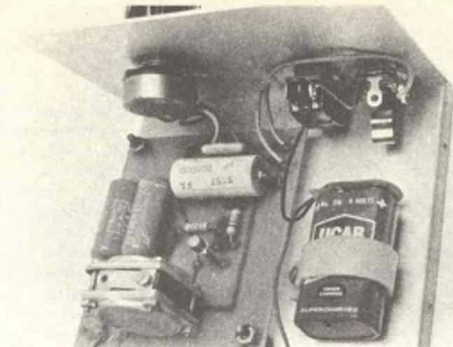
Esempio di possibile sistemazione della basetta nel contenitore.
