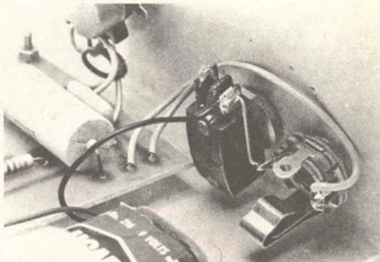
Particolare di montaggio. Per prelevare il segnale di bassa frequenza si è fatto uso di una connessione jack.
