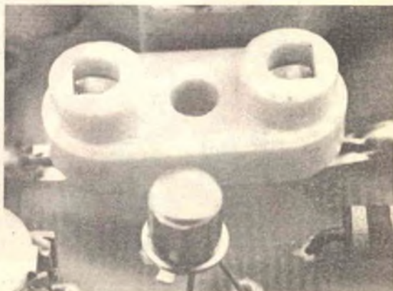
Per l'inserimento delle bobine di alta frequenza è consigliabile l'uso di uno zoccolo per quarzi in materiale ceramico.
