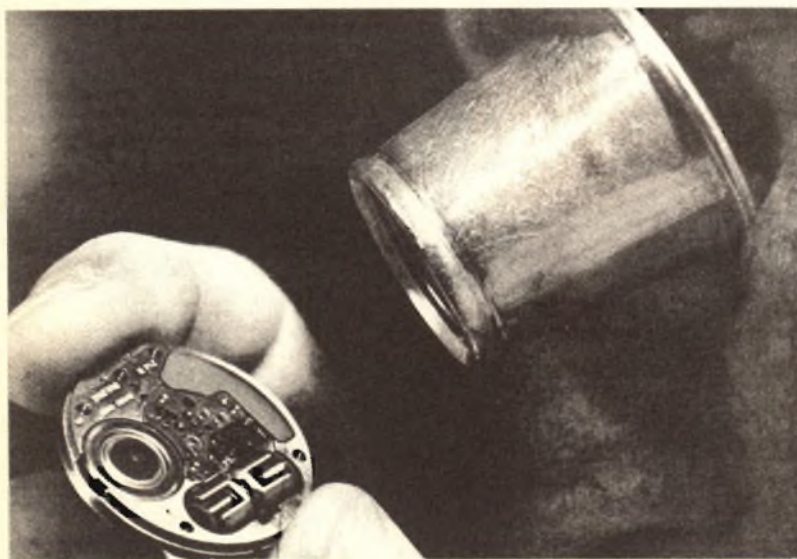
Una piccolissima pila al mercurio consente agli orologi tipo Bulova Acutron di funzionare per oltre un anno con precisione sbalorditiva.
