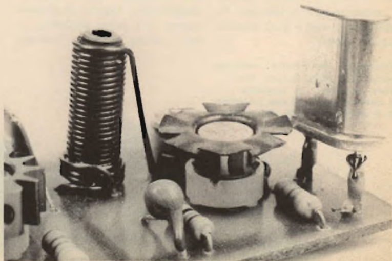
Vista prospettica della sezione oscillante quarzata. Sulla destra il cristallo adatto per la gamma CB.
