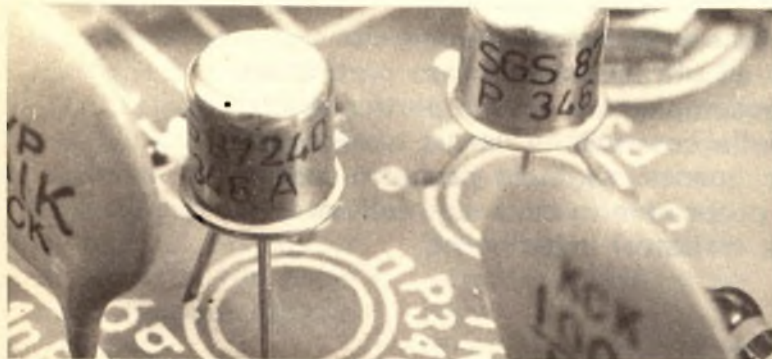
Particolare dello squadratore. Per facilitare la costruzione, come si vede nell'illustrazione, sulla basetta sono riprodotti serigraficamente i componenti ed i loro valori.
