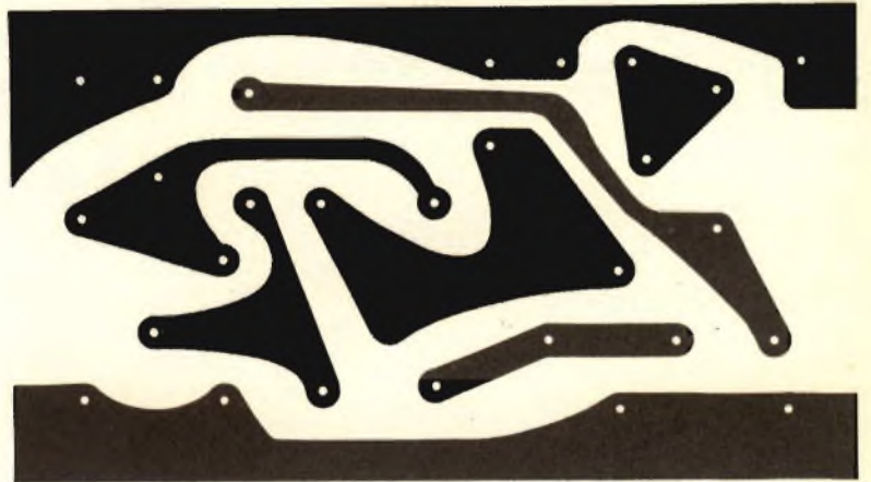
Traccia ramata del circuito di emissione.
