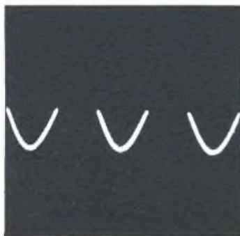
Fig. 16 - Un esempio di modulazione di luminosità, detta anche modulazione di brillantezza. In questo caso il rapporto fra frequenza nota e frequenza ignota è esattamente 1:1.
