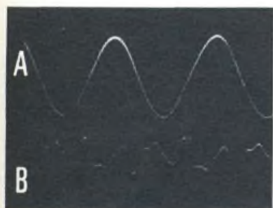
Fig. 33 - Visualizzazione di una interessante distorsione armonica: quella della frequenza di rete dell'alimentazione a 50 Hz. Anche in questo caso, in cui la distorsione raggiunge circa l'1%, è necessario disporre di un circuito a ponte per la visualizzazione.
