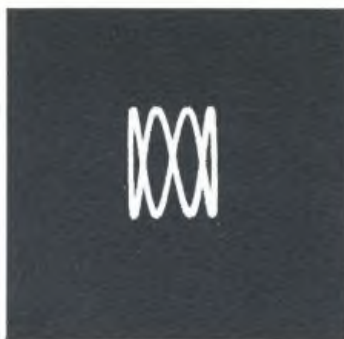
Fig. 15 - Una quadrupla figura di Lissajous. Sta a significare che la frequenza ignota è quadrupla rispetto alla frequenza nota. Lissajous (fisico francese, 1822-1880) studiò le vibrazioni.
