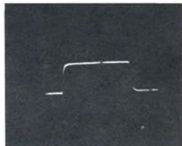
Fig. 3 - Un semiciclo di un'onda quadra di 100 kHz, applicata direttamente all'entrata dell'oscilloscopio. Per ottenere questa foto la base dei tempi di scansione è stata portata quasi al massimo. Il segnale è stato applicato all'ingresso Y.
