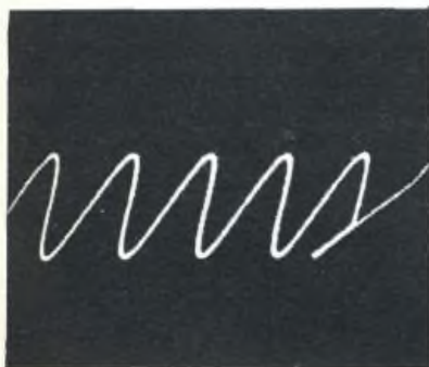
Fig. 6 - Le conseguenze di un'interferenza fra il generatore della base dei tempi di scansione e l'amplificatore Y, (verticale). Comparare questo foto con le fig. 22 (A) e 32 che, per la loro somiglianza, potrebbero trarre in inganno.
