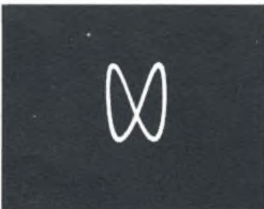
Fig. 13 - Una doppia figura di Lissajous. La frequenza incognita è maggiore di quella nota.
