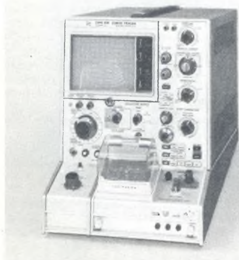
Vi sono oscilloscopi adatti anche a visualizzare direttamente le curve caratteristiche di un transistor. Nell'immagine il modello 576 della Tektronix.
