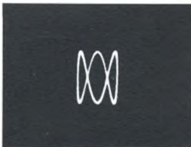
Fig. 14 - Una tripla figura di Lissajous. La frequenza incognita è tripla della nota.
