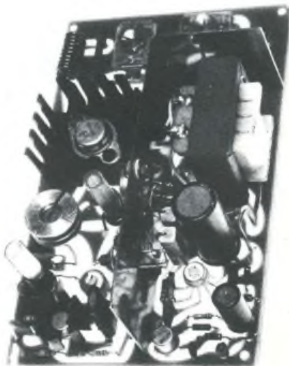
Il trasmettitore a realizzazione ultimata si presenta molto elegante e funzionale. Nell'immagine si distinguono nettamente le due sezioni di alta e bassa frequenza.
