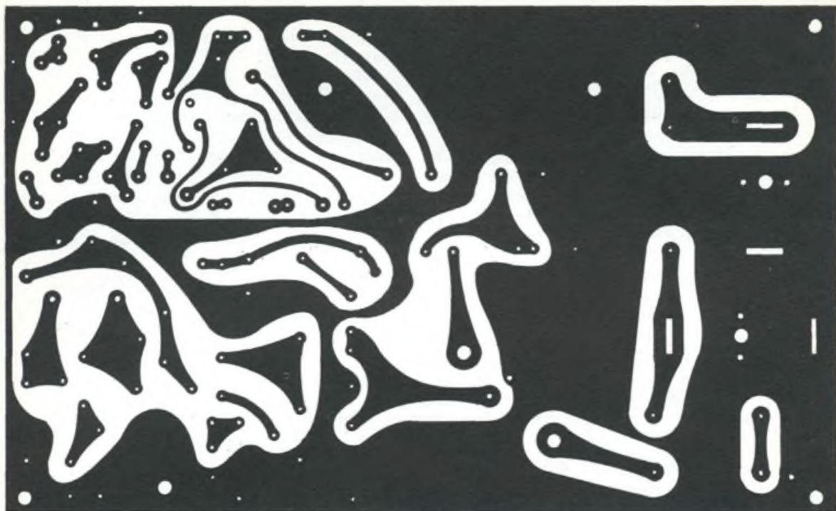
Traccia del circuito stampato vista dal lato rame. La bassetta stampata può essere richiesta alla segreteria del laboratorio di Radio Elettronica dietro versamento di lire 500.
