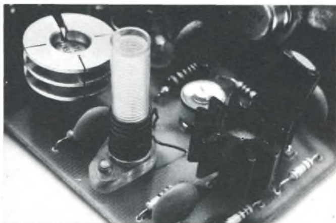
Particolare della bobina L1-L2 e del transistor oscillatore (a destra col dissipatore nero). A sinistra il pilota AF del tipo 2N 5320.
