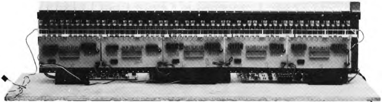
Foto 2 - Cablaggio delle piastre dei generatori d'involuppo, site sotto il vano della tastiera del pianoforte elettronico descritto in questo articolo, il quale conclude la serie che ONDA QUADRA ha presentato per permettere ai propri lettori di autocostruire un valido pianoforte elettronico.
