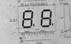
Fig. 1 - Dimensioni di segmento in mm, e collegamenti agli elettrodi dell'indicatore numerico ZM 1550.
