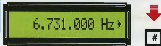
Fig.17 Dopo aver digitato il numero richiesto per prelevare dall'uscita del Generatore DDS questa frequenza dovete premere il tasto # in modo che appaia sulla destra di Hz il simbolo di conferma >.
