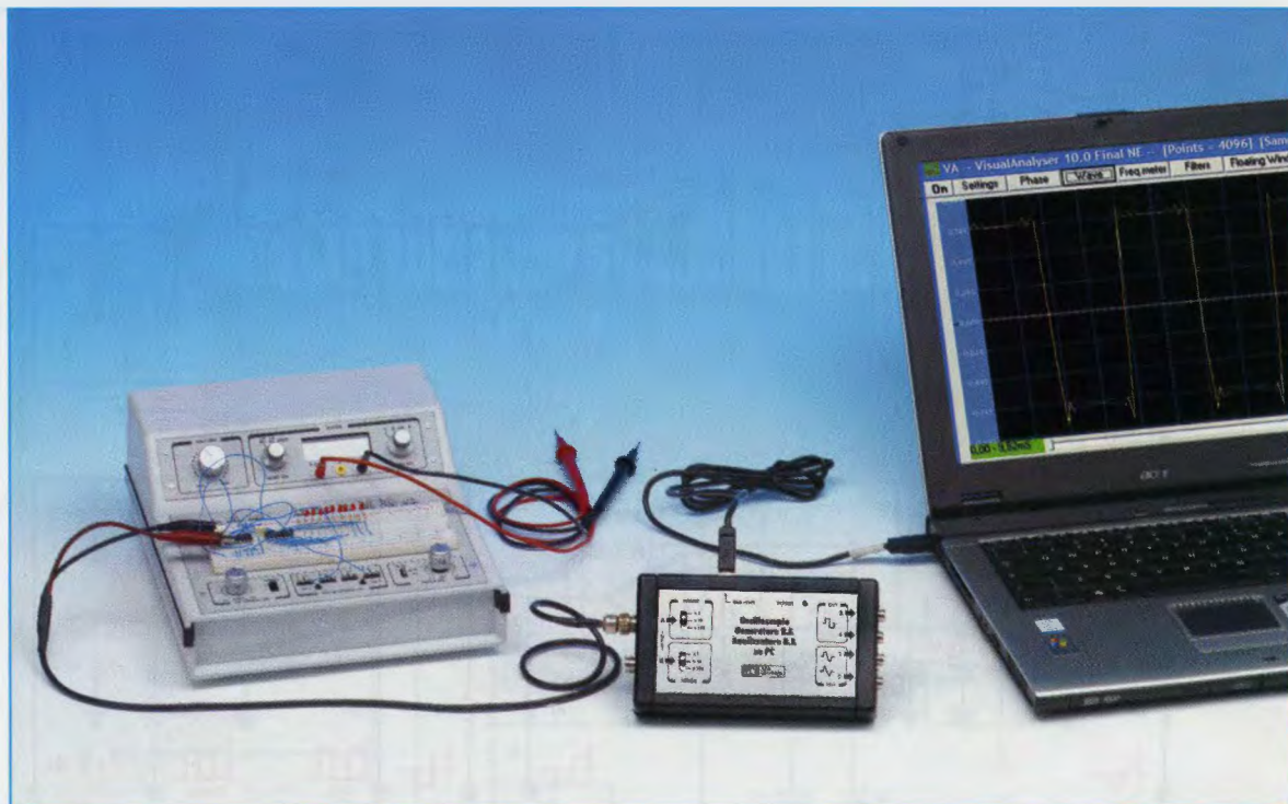
Fig.3 Se avete a disposizione un pc, collegando alla presa USB la nostra interfaccia LX.1690 pubblicata nella rivista N.232 ed installando il relativo software avrete a disposizione lo strumento principe di ogni vero laboratorio di elettronica: l'oscilloscopio. In questo modo sarete in grado di "vedere" i segnali elettronici sullo schermo del vostro pc.
