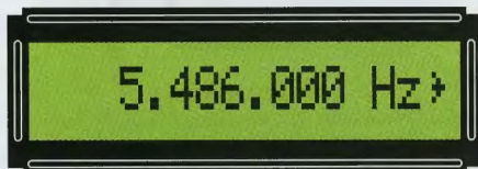
Fig.5 Dopo aver digitato il numero richiesto se desiderate prelevare dall'uscita del Generatore DDS questa frequenza, dovete premere il tasto # in modo che appaia sulla destra di Hz il simbolo di conferma >.
