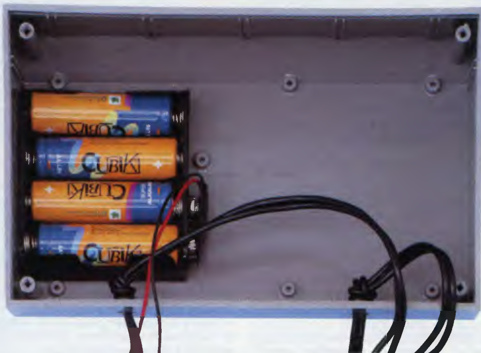
Fig.11 Sul piano interno di questo mobile plastico fisserete con una goccia di attaccatutto il supporto del portapile. Quando inserirete nel vano appositamente predisposto le 4 pile a stilo da 1,5 Volt, controllatene la polarità facendo in modo che il polo positivo risulti rivolto verso il lato indicato con il segno +.
