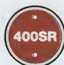
Fig.2 Sul retro del corpo della capsula RICEVENTE è stampigliata la sigla 400SR . Le altre scritte che troverete sotto a tale sigla non sono significative.
