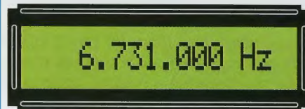
Fig.16 Sapendo che una induttanza da 18 microH con in parallelo una capacità di 22 pF + 9 pF di capacità parassita si dovrebbe accordare sui 6.731.000 Hz, digitate questo numero tramite tastiera.
