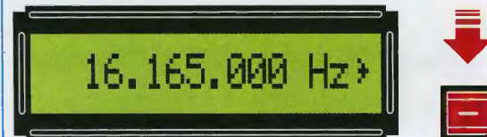
Fig.29 Per sintonizzarvi con una maggiore precisione sulla frequenza di sintonia, vi conviene variare le migliaia di Hz, quindi dopo aver sottolineato il numero 7 premete il tasto - fino a leggere 16.165.000 Hz.
