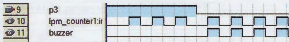
Fig.8 In questo grafico è visibile l'uscita del contatore "q1[11]" che si commuta a ciclo continuo dal livello logico 1 al livello logico 0 in funzione della frequenza di conteggio e che poi viene trasferito al buzzer solo quando viene premuto il pulsante "p3".
