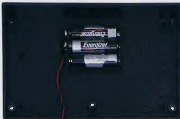
Fig.5 Nel semicoperchio base del mobile plastico dovete fissare il portapile con una goccia di comune attaccatutto. All'interno del supporto dovete inserire 3 pile a stilo da 1,5 Volt facendo attenzione a rispettarne la polarità +/- che troverete indicata nei rispettivi vani di alloggiamento.
