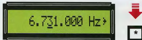
Fig.19 Poichè inizialmente conviene variare la frequenza delle decine di migliaia di Hz, dovete premere il tasto * in modo da sottolineare il numero 3 posto sulla quinta posizione contando da destra.
