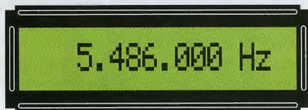
Fig.4 Sapendo che una induttanza da 15 microH con in parallelo una capacità di 47 pF + 9 pF di capacità parassita si dovrebbe accordare sui 5.486.000 Hz, digitate questo numero sulla tastiera.
