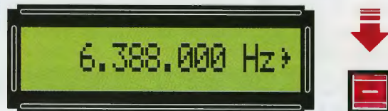
Fig.20 Per sintonizzarvi con una maggiore precisione sulla frequenza di sintonia, vi conviene variare le migliaia di Hz, quindi dopo aver sottolineato il numero 1 premete il tasto - fino a leggere 6.388.000 Hz.
