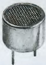
Fig.1 Sul retro del corpo della capsula TRASMITTENTE è presente la sigla 400ST . Le altre scritte che troverete sotto a tale sigla non sono significative.
