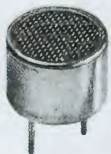
Fig.2 Sul retro del corpo della capsula RICEVENTE è stampigliata la sigla 400SR . Le altre scritte che troverete sotto a tale sigla non sono significative.
