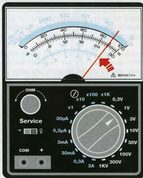
Fig.10 Per conoscere il valore delle frequenze F1-F2 a - 3 dB dovete premere i tasti + e - del Generatore DDS fino a portare la lancetta del tester sulla posizione 90 che corrisponde a 0,9 Volt.
