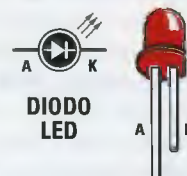
Fig.1 Dal corpo di un diodo led escono due terminali chiamati Anodo e Katodo. Il terminale più lungo, chiamato Anodo, va sempre collegato alla tensione positiva, mentre il terminale più corto, chiamato Katodo, va sempre collegato alla tensione negativa.
