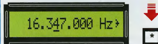
Fig.28 Poichè inizialmente conviene variare la frequenza delle decine di migliaia di Hz, dovete premere il tasto * in modo da sottolineare il numero 4 posto sulla quinta cifra, contando da destra.
