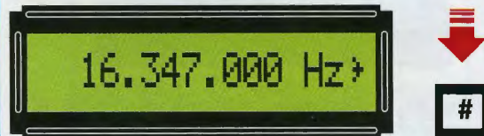
Fig.26 Dopo aver digitato il numero richiesto, per prelevare dall'uscita del Generatore DDS questa frequenza premete il tasto # in modo che appaia sulla destra di Hz il simbolo > di conferma.
