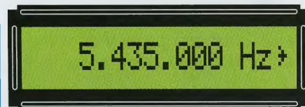
Fig.8 Per sintonizzarvi con una maggiore precisione sulla frequenza di sintonia, vi conviene variare le migliaia di Hz, quindi dopo aver sottolineato il numero 6 premete il tasto - fino a leggere 5.435.000 Hz.
