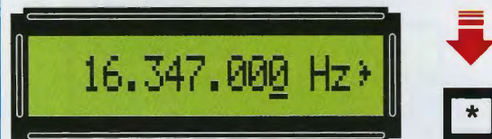
Fig.27 Per variare la frequenza impostata occorre premere il tasto * e noterete che il primo 0 di destra verrà sottolineato per segnalare che, premendo i tasti + o -, si modificherà questo numero.
