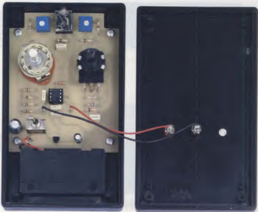
Fig.11 Foto del circuito stampato collocato nel mobile. Il cablaggio non richiede attenzioni particolari, se non il rispetto delle polarità + (rosso) e - (nero). Sul coperchio sono fissate le due bocche per i puntali del tester. Per un corretto montaggio di queste bocche, che vanno isolate dal metallo della mascherina, guardate il disegno in fig.10.
