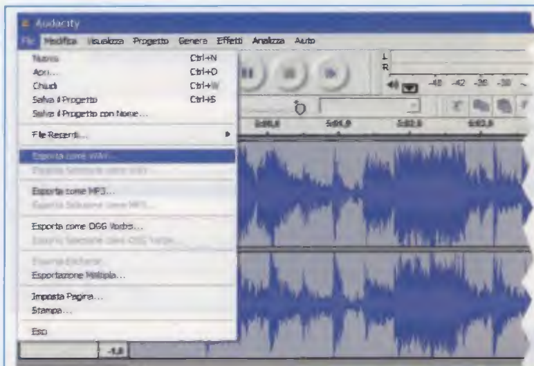
Fig.8 Una volta registrato un brano musicale, per poterlo trasferire su CD-Rom dovete cliccare su File del menu e poi su Esporta come Wav. Nota: abbiamo scelto il formato Wav perché viene letto agevolmente da NERO (vedi fig.12).
