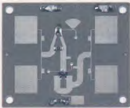
Fig.2 Ecco come si presenta il modulo radar visto frontalmente. Sono ben visibili le quattro piazzole in rame di forma rettangolare, delle quali 2 fungono da antenne trasmettenti e 2 da riceventi.
