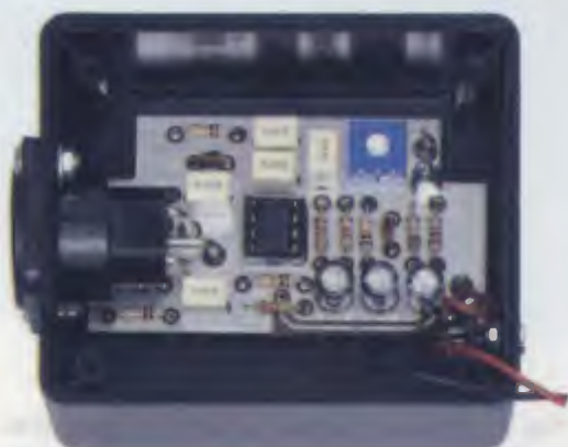
Fig.12 Come si presenta lo stampato del preamplificatore montato nel mobile.
