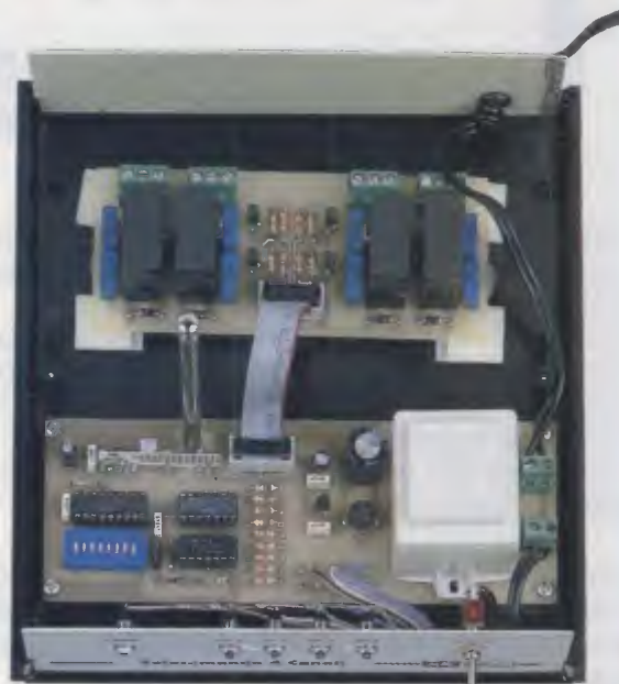
Fig.6 La foto mostra l'alloggiamento della scheda a 4 relè di fig.4 all'interno del mobile del ricevitore LX.1410.
