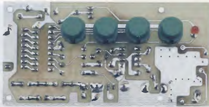
Fig.3 Foto del circuito del trasmettitore LX.1474 visto dal lato in cui vanno montati i quattro pulsanti utilizzati per eccitare i 2 o 4 relè delle schede LX.1411 e LX.1412.
