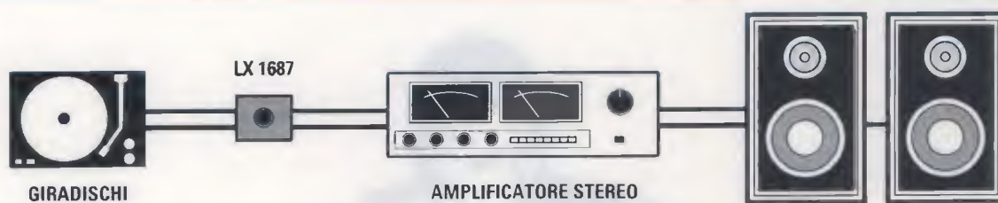
Fig.5 Il soppressore di rumore e fruscio va collegato tra il giradischi e lo stadio amplificatore.
