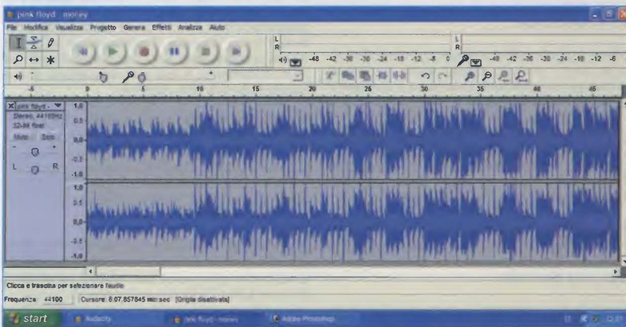
Fig.1 Il convertitore audio stereo USB consente di registrare sull'hard disk del personal computer qualsiasi brano musicale proveniente dalla testina di un giradischi, da una piastra di registrazione o da un lettore CD-Rom. Con il software "Audacity" che forniamo a corredo, potrete divertirvi a rielaborare i brani da voi registrati utilizzando i numerosi effetti speciali disponibili.
