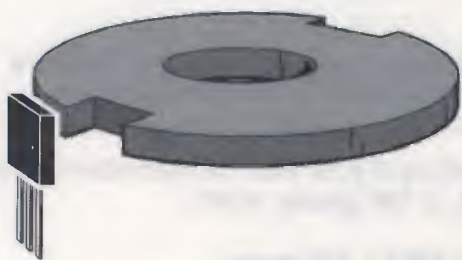
Fig.15 I sensori ad effetto di Hall sono utilizzati, tra l'altro, come contatori, per contare i denti di un ingranaggio o di una ruota dentata, oppure per trovare il punto di sincronismo di un meccanismo.
