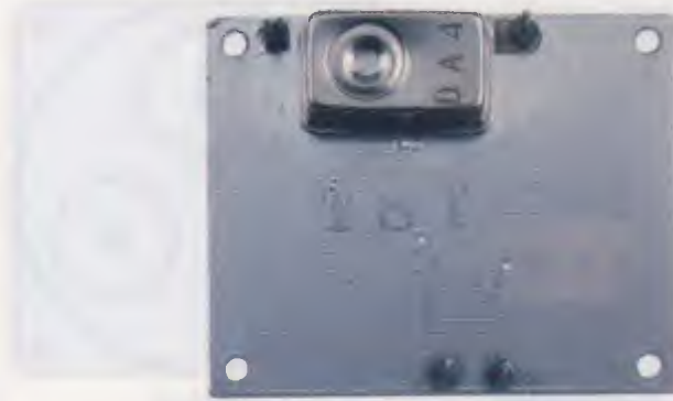
Fig.3 Come potete notare, sul retro del circuito stampato trova posto il minuscolo modulo DRO, cioè lo stadio oscillatore utilizzato per generare la frequenza dei 10 GHz.
