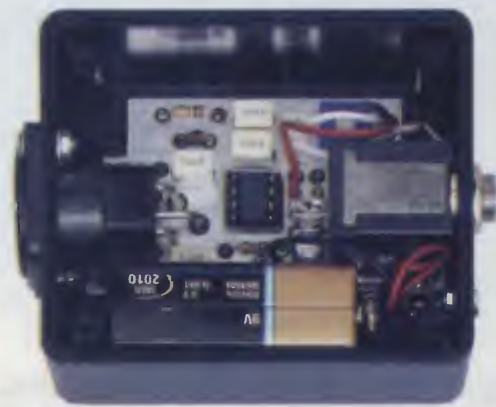
Fig.13 Prima di chiudere il contenitore inserite la pila e collegatela alla sua clip.
