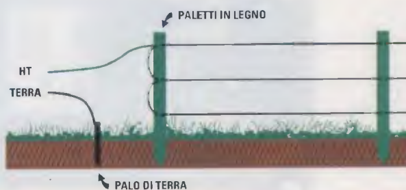
Fig.2 Se i paletti del vostro recinto sono di metallo, dovrete isolarli dal filo utilizzando degli isolatori in ceramica. Conviene inoltre racchiudere la bobina per auto all'interno di un contenitore plastico che fesserete vicino ai paletti della recinzione.
