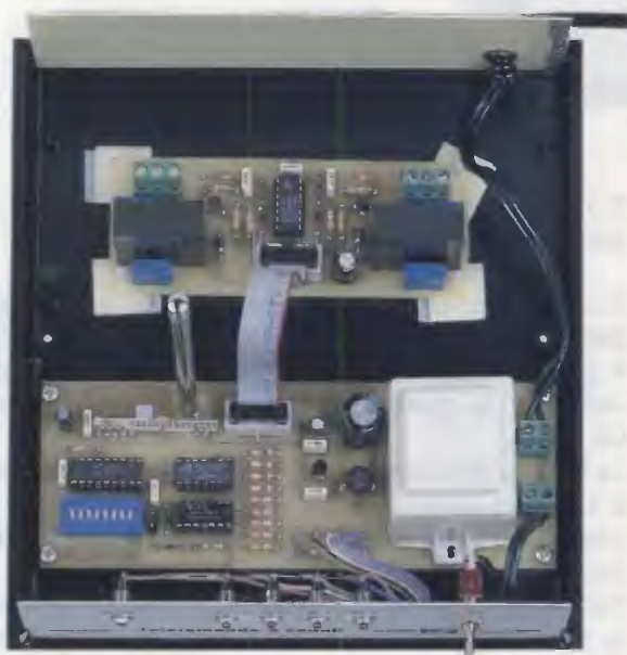
Fig.5 In questa foto potete vedere il montaggio della scheda a 2 relè di fig.3 nel mobile del ricevitore LX.1410.
