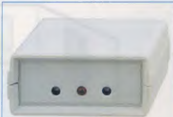
Fig.1 Foto dell'antifurto radar a 10 GHz che utilizza il modulo DRO. Come potete notare, non è necessario aprire una finestra sul coperchio del mobile, perché il fascio delle onde a 10 GHz lo attraversa senza subire alcuna attenuazione.
