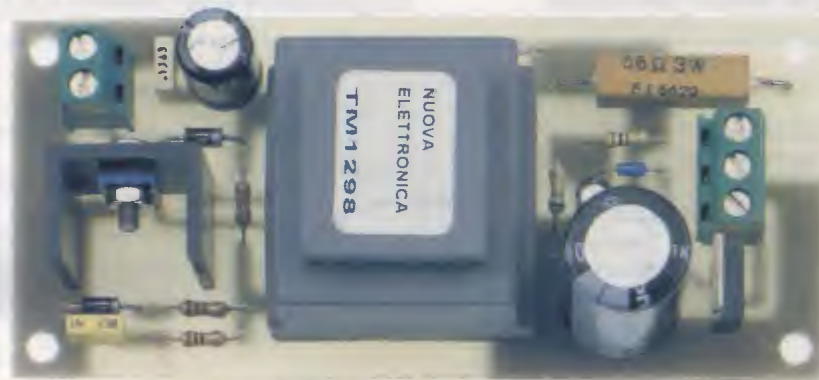
Fig.4 Foto che riproduce il circuito montato. In alto a sinistra potete vedere la morsettiera a due poli per il collegamento alla batteria da 12 Volt oppure ad un alimentatore stabilizzato collegato alla rete dei 230 Volt, in grado di erogare una tensione di 12 Volt con 0,5 Ampere. Come potete notare, il transistor TR1, visibile a sinistra, va applicato sopra una piccola aletta di raffreddamento.
