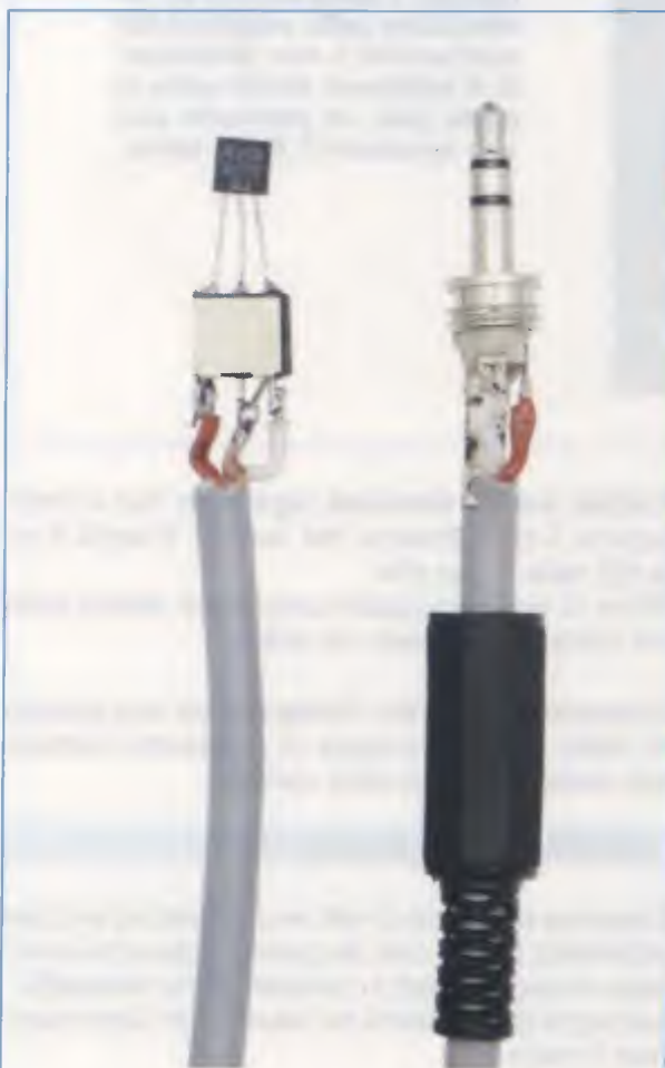
Fig.8 Foto della sonda vista dal lato del sensore e dal lato dello spinotto jack stereo. Il condensatore al poliestere da 100.000 picofarad deve essere saldato ai terminali + ed M del sensore (vedi fig.1).
