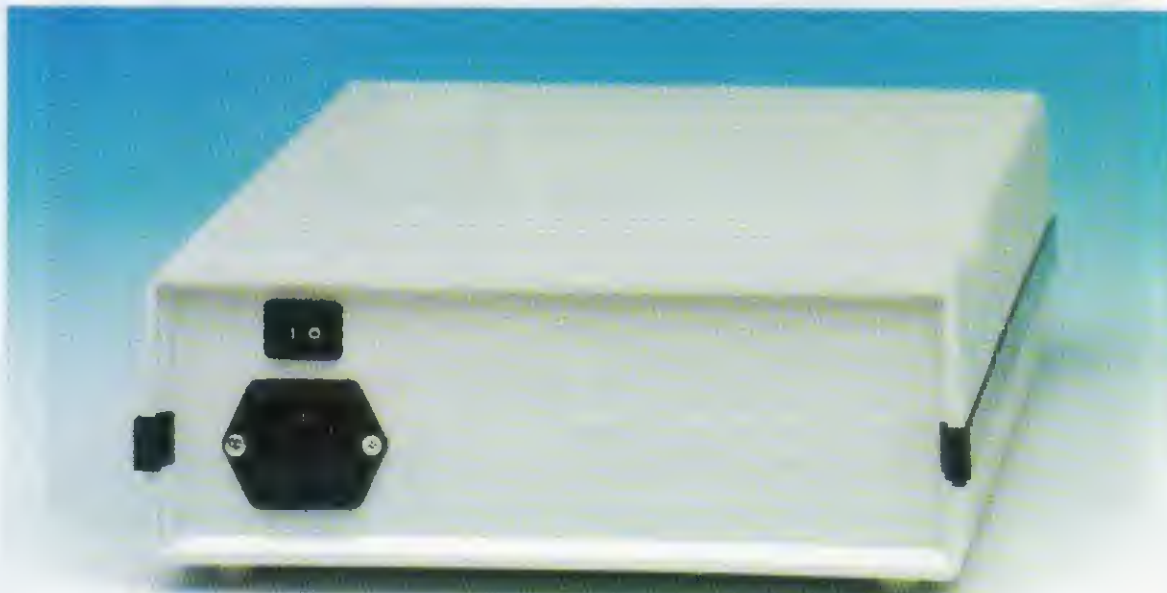
Fig.16 Il contenitore plastico della magnetoterapia visto da dietro. Sul pannello posteriore, che vi forniamo già forato, vanno incassati l'interruttore e la presa di rete.
