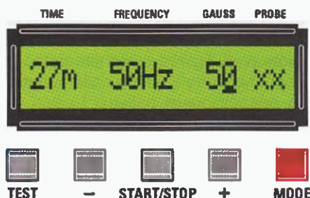
Fig.27 Per impostare la potenza premete il pulsante Mode fino a sottolineare il valore numerico relativo alla scritta Gauss , quindi premete i pulsanti + e - .
