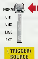
Fig.2 Per sincronizzare il segnale occorre invece porre il tasto del Trigger Source in posizione NORM (Normal).
