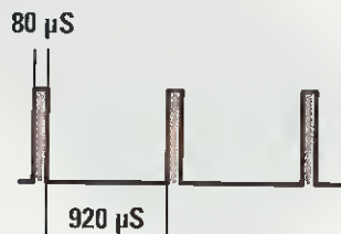
Fig.3 Lo stadio trasmettente riprodotto in fig.2 eccita i diodi trasmettenti per un tempo di 80 microsecondi con degli impulsi idonei a far loro assorbire una corrente di circa 400 milliamper.
