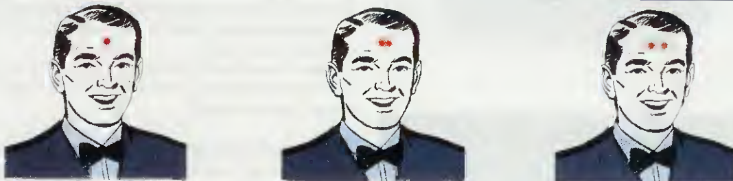
Fig.21 Per misurare la temperatura della pelle dovete tenere premuto il pulsante e avvicinate il termometro alla pelle fino a quando vedete formarsi un bel cerchio rosso. A questo punto rilasciate il pulsante e aspettate che i led lampeggino 4 volte: potrete così leggere sul display LCD la temperatura della pelle in quell'istante. Se invece di un cerchio vedete un'ellisse dovete avvicinarvi, se vedete un otto vuol dire che siete troppo vicini.
