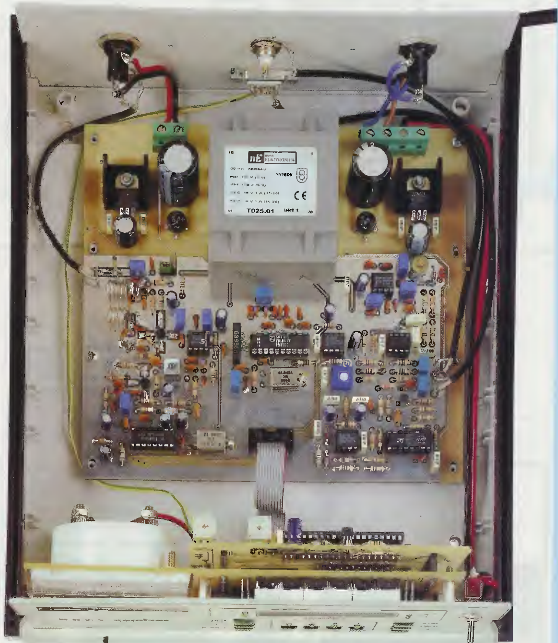
Fig.23 Foto dell'interno del mobile di questo ricevitore. Il circuito stampato base siglato LX.1495 viene fissato sul piano base del mobile con 8 viti autofilettanti. Gli altri due circuiti stampati LX.1496 e LX.1496/B vengono fissati sul pannello frontale del mobile. Si noti in basso la piattina cablata che viene utilizzata per collegare il circuito stampato base LX.1495 di fig.20 al circuito stampato LX.1496 di fig.21.
