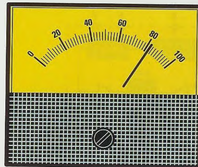
Fig.16 Se il satellite risulta ben centrato, la lancetta dello strumento devierà verso il fondo scala. L'abilità dell'operatore consiste nel riuscire a mantenere la lancetta deviata sempre sul massimo agendo sulle leve del box Controllo Motore (vedi fig.26).
