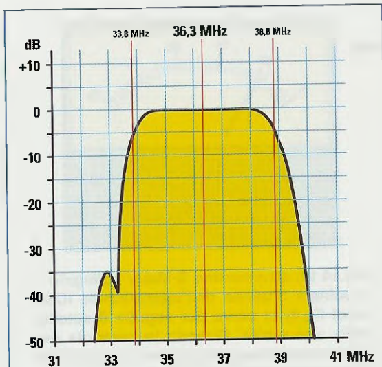
Fig.11 Il filtro FC1 è centrato sui 36,3 MHz e dal grafico si vede che ha una larghezza di banda di 5 MHz con una attenuazione di -10 dB e una larghezza di banda di 7 MHz con una attenuazione di ben -40 dB.
