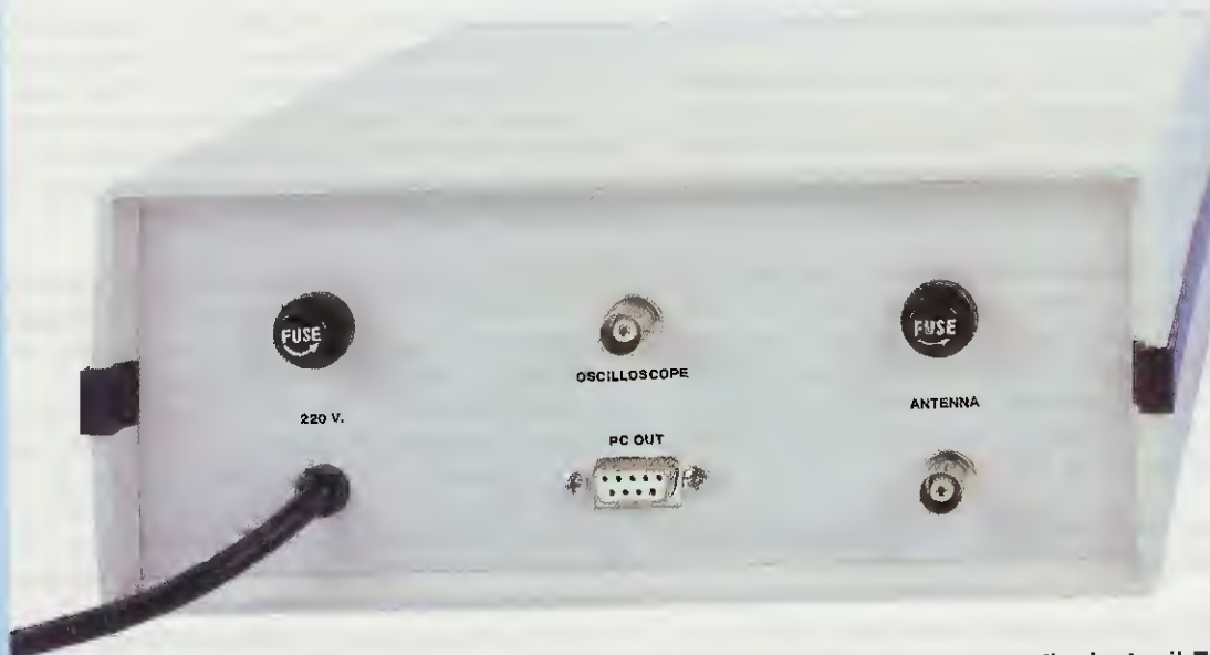
Fig.25 Sul pannello posteriore trovate sulla sinistra il Fusibile di Rete e sulla destra il Fusibile che alimenta il convertitore TV.970 fissato alla parabola. Nel BNC posto sulla destra va inserito il segnale RF che preleverete dal convertitore TV.970, mentre nel connettore PC OUT va inserito il cavo seriale che andrà poi a collegarsi alla interfaccia LX.1497 presentata sempre in questa rivista. Se nel BNC posto al centro collegate un oscilloscopio, vedrete i segnali che abbiamo riportato nelle figg.17-18-19.
