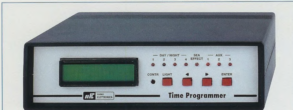
Fig.1 Sul pannello frontale di questo Timer sono presenti un Display LCD e quattro pulsanti che vi permetteranno di programmare i tempi di accensione e spegnimento. Ogni volta che si ecciterà un relè, vedrete accendersi un diodo led sul pannello frontale.
