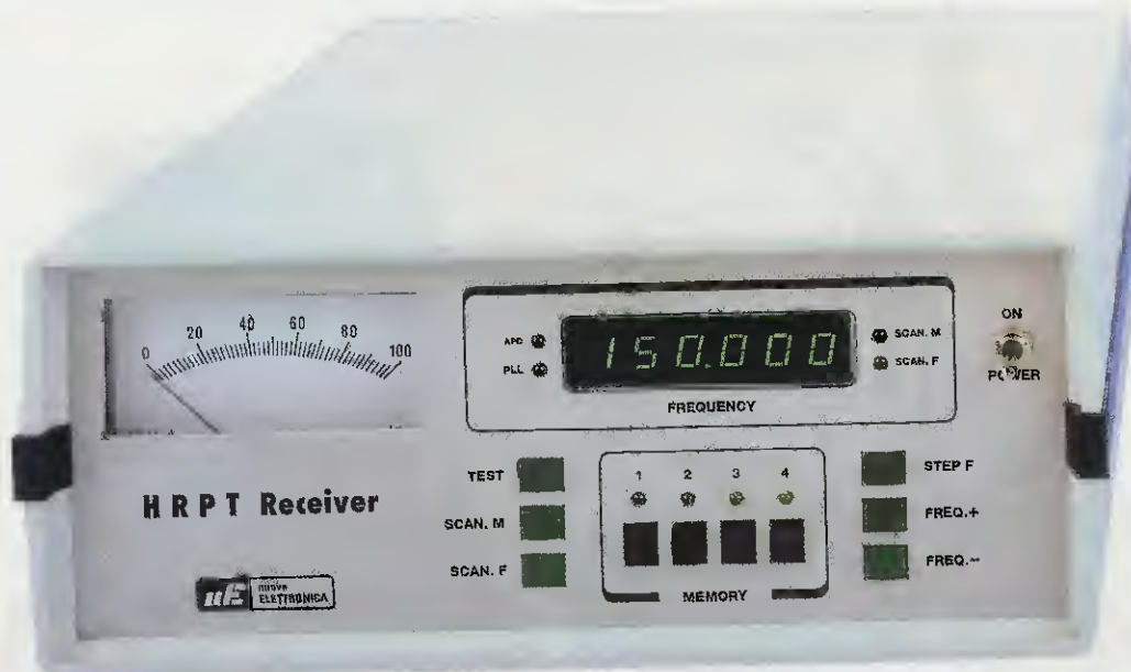
Fig.24 Dei 10 pulsanti presenti sul pannello frontale, il primo siglato Test serve per la taratura del ricevitore. I due pulsanti SCAN M e SCAN F servono per la scansione della memoria e della frequenza. I 4 pulsanti Memory servono per vedere sui display le frequenze dei satelliti HRPT memorizzate nel micro. Con il primo pulsante a destra STEP F si selezionano le centinaia, le decine e le unità di KHz della frequenza che appare sui display, mentre con i pulsanti FREQ + e FREQ - si varia la frequenza (leggere testo).
