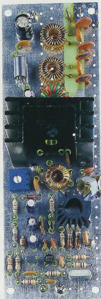
Fig.4 Foto del trasmettitore visto verticalmente. Se sostituite il valore del quarzo e modificate il numero di spire delle bobine, potete far funzionare questo circuito anche sui 7 MHz.
